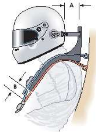
Рис.15-10 Минимальное расстояние между ярмом устройства HANS® и местом сочленения двойных ремней.
